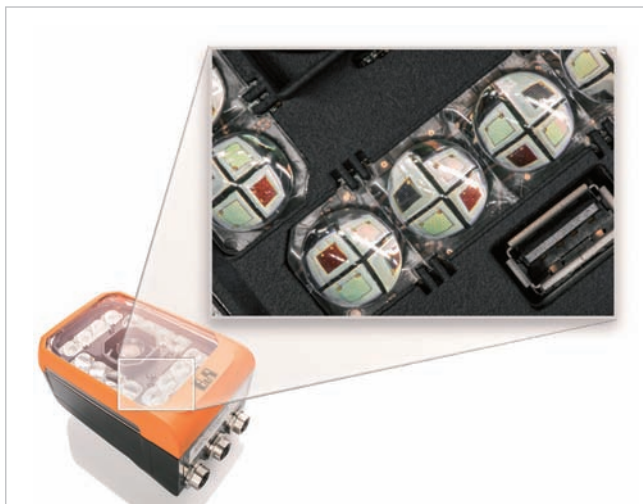
Každé svetlo v portfóliu B&R podporuje až štyri rôzne farby. Špeciálne vyvinuté šošovky zabezpečujú rovnomerné osvetlenie.
